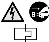
サーマルプロテクターが動作した場合は、すぐに本機の元電源を切ってください。(保護装置による電源の遮断が望ましいです。) サーマルプロテクターはモータが過負荷運転となった時、モータ内部温度が上昇(約120°C前後)すると、自動的に働いてモータの運転を停止させます。また、停止後モータ内部の温度が低下(約80°C前後)すると、サーマルプロテクターは自動的に復帰(接点が導通)しますので、電源が投入されたままの状態では復帰と同時にモータの運転が再開されます。サーマルプロテクターは動作後にモータ内部温度の低下(約80°C前後)により自動復帰し運転が自動的に再開される仕様ですので、電源が投入された状態のままで突然モータの運転が再開され予期せぬ事故の発生原因となるおそれがあり大変危険です。自動復帰による事故防止の為、必ず本機の元電源を切ってください。尚、サーマルプロテクターが動作した原因を究明・除去するまでは、運転を再開させないでください。
