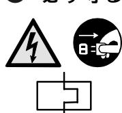
モータ内部に過負荷保護装置のサーマルプロテクターが内蔵されています。(但し、単相100V、単相200V、三相200Vの日本標準仕様のみ内蔵)
