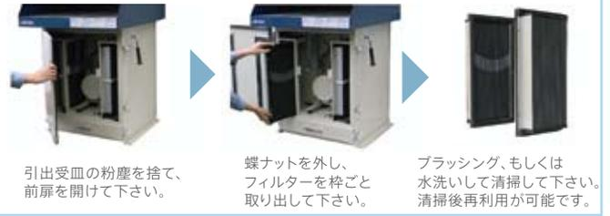
メインフィルターは通常の場合、破損が発生しない限り交換の必要はありません。(0.4kW以上機種はシェイキング装置を稼働することにより最適性能に回復できる設計です。) まれに吸引ダストの性質やひどい汚れの為、性能が維持できなくなる場合があります。この場合は清掃(ブラッシング・水洗い)を行ってください。清掃後も性能が回復しない、あるいは、清掃後すぐに性能低下する場合は新しいフィルターと交換して下さい。
