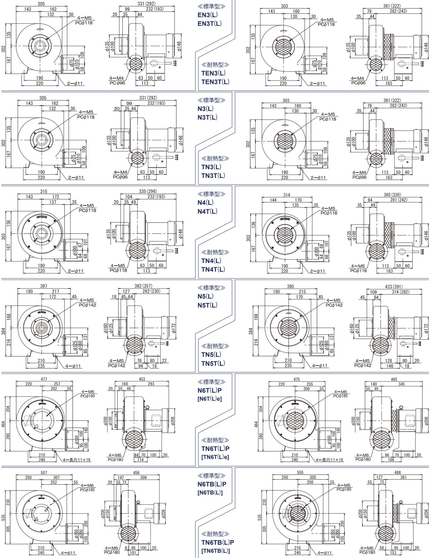
※ 上記外形寸法図は全て右回転タイプです。左回転タイプは上記各寸法図の吐出口及びモータを右から左に反転させてご利用ください。その場合、電源コード位置や端子箱も、接続最適側に反転します。
