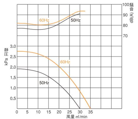
NK2L タイプの性能曲線・外形寸法図は
