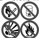
火気および引火性・爆発性・可燃性粉塵及び爆発性・引火性・可燃性物質の付着した粉塵・混在した粉塵等は絶対吸引させないでください。
