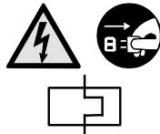
SET75P型のみモータ内部に過負荷保護装置のサーマルプロテクターが内蔵されています。(但し、三相200Vの日本標準仕様のみ内蔵) サーマルプロテクターが動作した場合は、すぐに本機の元電源を切ってください。(保護装置による電源の遮断が望ましいです。)
